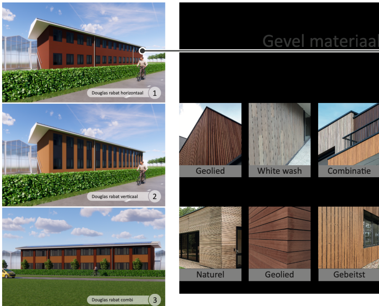
Afbeelding 4: Schetsontwerpen met verschillende soorten gevelmateriaal
